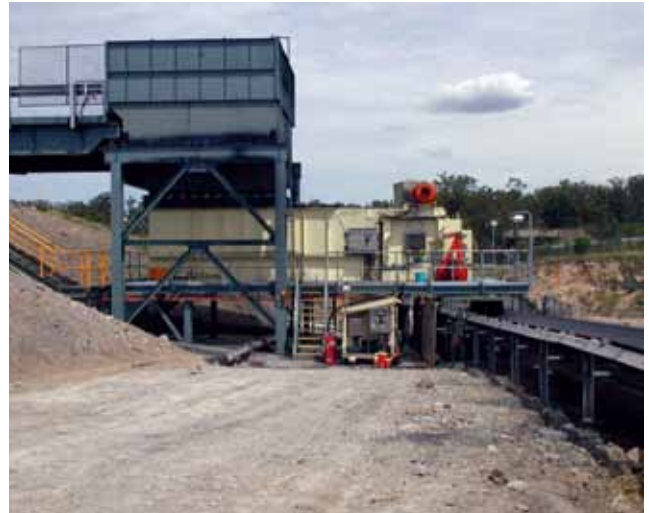
Установленная стационарно дробилка-питатель дробит уголь до размера минус 200 мм при производительности 1,500 тонн в час.
