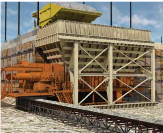
Установленная на полозьях дробилка-питатель дробит вскрышные породы до размера минус 260 мм при производительности от 0 до 5,000 тонн в час.
