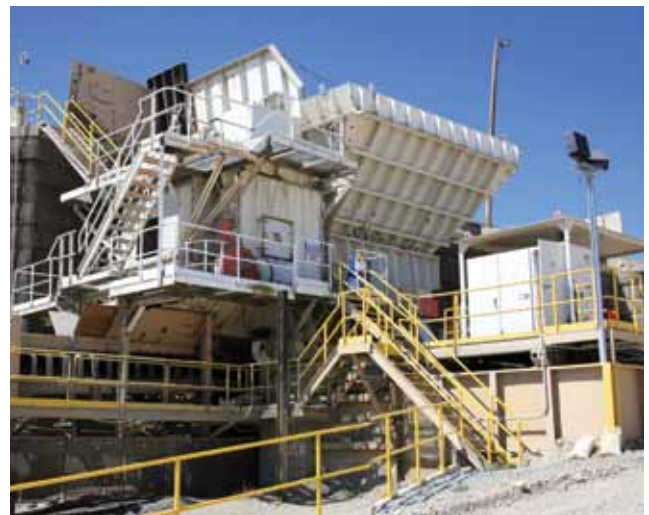
Установленная на полозьях дробилка-питатель с 300 тонным бункером дробит фосфатную руду до размера минус 260 мм при производительности 2,000 тонн в час.
